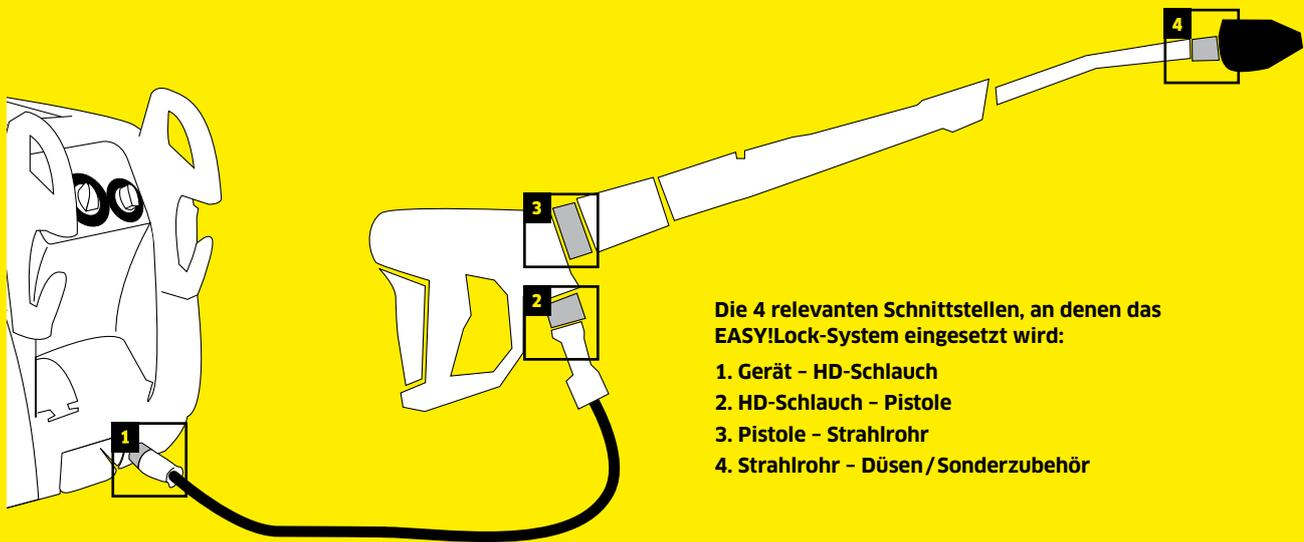
Die 4 relevanten Schnittstellen, an denen das EASY!Lock-System eingesetzt wird:
